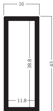
Z 100 Zargenprofil 43 mm 3.14 kg | 5000 mm
