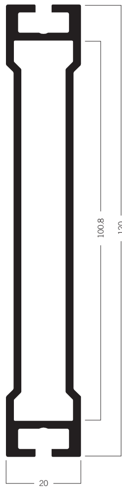
U 1030* Zargenprofil 120 mm 9.51 kg | 6000 mm
