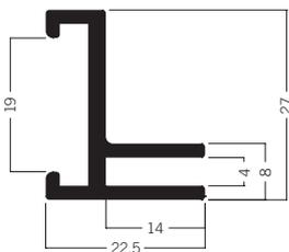
**M 1309** Spannrahmenprofil für Kleinformate bis 841 × 1189 mm (DIN A0), 22,5 mm
