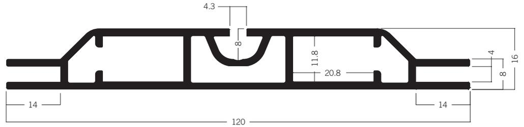
**M 1901** Spannrahmenprofil für Leuchtrahmen 120 mm
