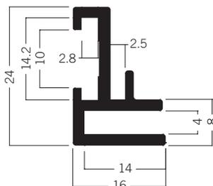
**M 1607** Spannrahmenprofil für Kleinformate bis 594 × 841 mm (DIN A1), 16 mm
