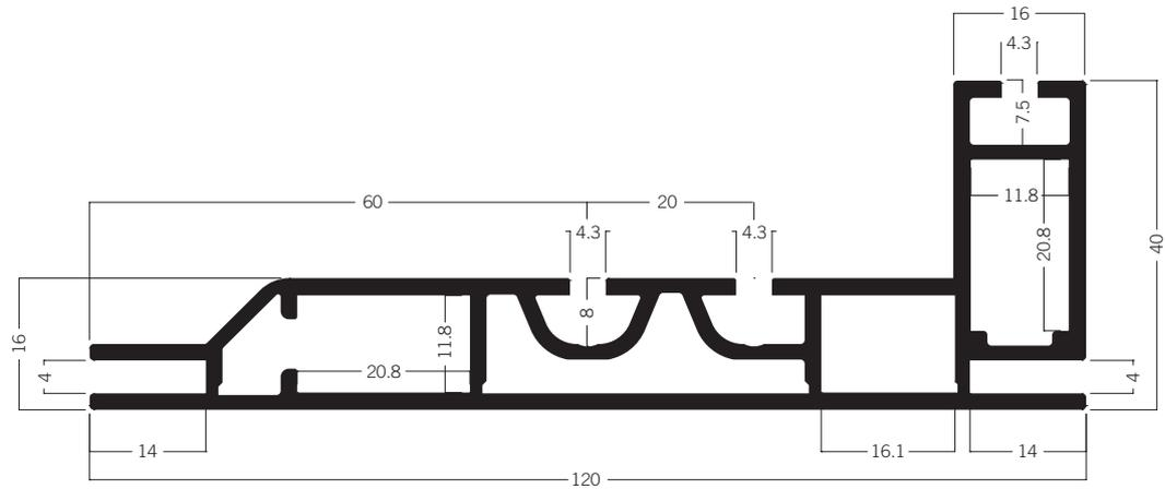
**M 1915** Spannrahmenprofil für Leuchtrahmen 120 mm
