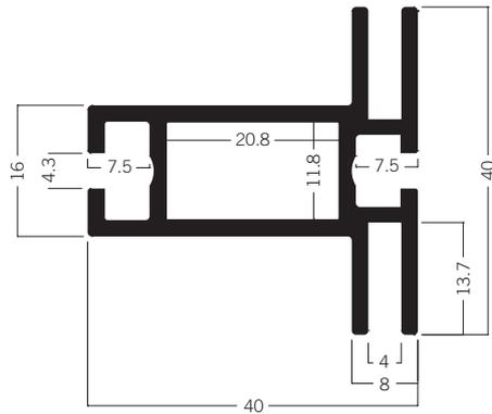
**M 1307** Spannrahmenprofil für beidseitige Stoffbefestigung 40 mm
