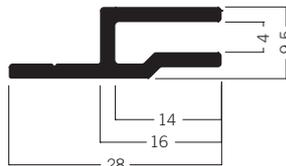
**M 1614** Spannrahmenprofil 28 mm
