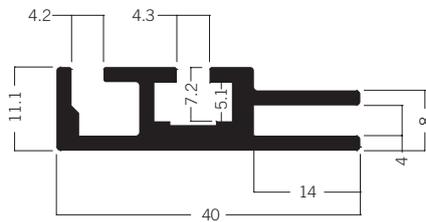
**M 1930** Spannrahmenprofil für Leuchtrahmen 40 mm
