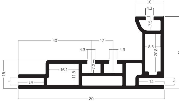
**M 1935** Spannrahmenprofil für Leuchtrahmen 80 mm
