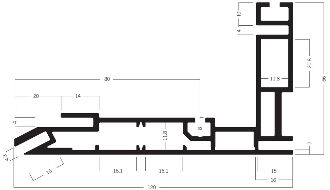
**U 1060** Spannrahmenprofil für Leuchtrahmen mit mehreren Stoffschichten 120 mm
