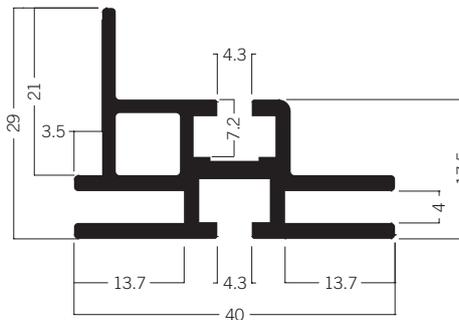
**M 1970** Spannrahmenprofil für Leuchtrahmen 40 mm
